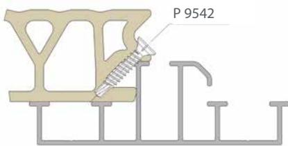
Vorbohrung 3 mm
