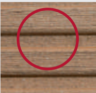
natürlicher Fasereinschluss nach mechanischer Behandlung
