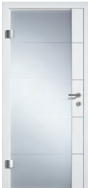
CORSO 15/L Teilglastür mit schlossseitigem Fries farblackiert, Dekoreinlage chromfärbig matt, (oberflächenbündig mit Zarge, passend zu FOCUS 11) Glas: Design 21/S, Satinato mit Rillenschliff
