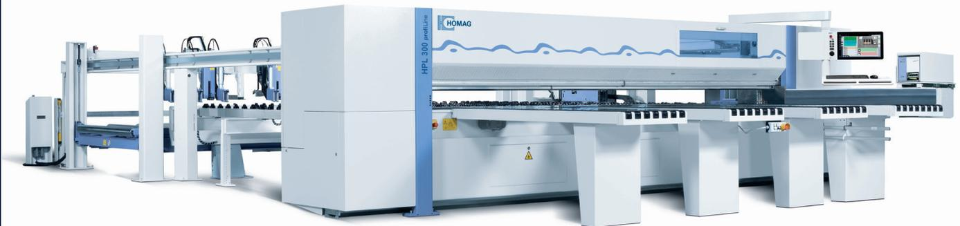
Mit den neuen, hochmodernen und computergestützten Plattensägen schneiden wir bis zu einer Länge von 5610 mm
