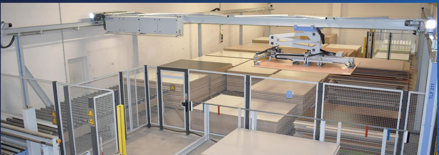
Die vollautomatische Beschickung unserer Sägen durch unser Flächenlager verhindert Oberflächenfehler (Kratzer) und erzielt ein perfektes Ergebnis durch verbesserte und schnellere Abläufe
