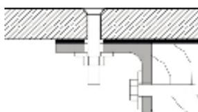
Fugen/Löcher müssen mit Fugenmasse versiegelt werden, um die Aufnahme von Wasser (Quellgefahr) zu vermeiden.
