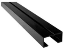
**Aluminiumleisten** kommen bei schwierigen Belüftungsverhältnissen zum Einsatz, etwa auf schattigen Bereichen, in Umgebungen mit hoher Luftfeuchtigkeit oder wo die Gefahr von Staunässe besteht. Aluminium ist widerstandsfähiger gegen Umweltbedingungen und somit länger haltbar im Vergleich zu einer Holzunterkonstruktion. Da Aluminium keinen Verzug aufweist, erleichtert es die Verarbeitung und ist daher sehr beliebt.
