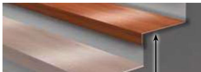
Trittstufe durchgängig (ohne Stoß)
