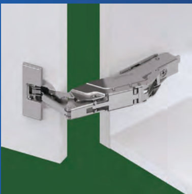
Weitwinkel - Mittelbander 160° halb aufliegend 9,5 mm gekropft
