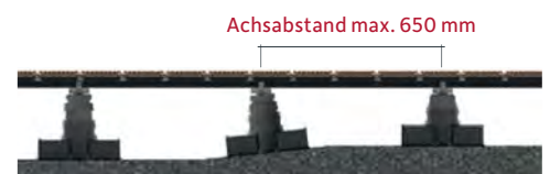
VARIO FIX mit Konstruktionsbalken 40 x 60 mm
