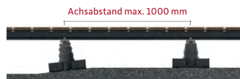
VARIO FIX mit Konstruktionsbalken 80 x 60 mm
